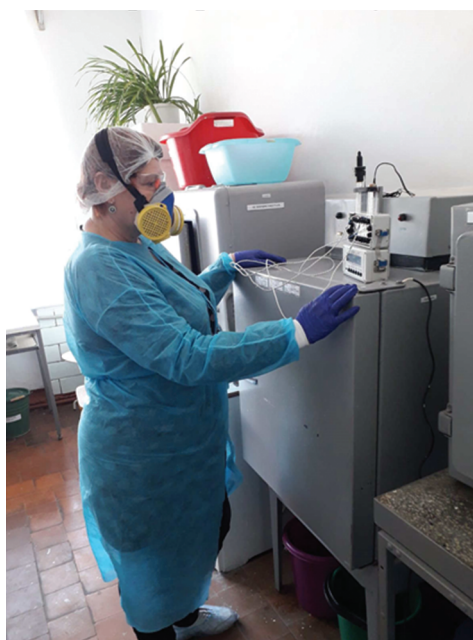
На фото: інженер з метрології 1 категорії Блажівська Л. А. проводить контроль та вимірювання температурних параметрів сушильних шафи в Каховській міжрайонній державній лабораторії ДПСС
