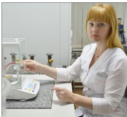
Заместитель начальника научно-технического отдела теплотехнических измерений Шустак С.Б. проводит взвешивание образцов зерна для определения влажности
