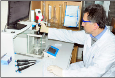
Заместитель начальника научно-технического отдела метрологического обеспечения механических измерений, измерений уровня и объема веществ Хасхачих Г.Г. проводит калибровку дозаторов пипеточных
