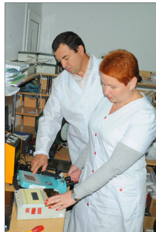
Начальник научно-технического отдела метрологического обеспечения теплотехнических измерений Гончарук В.Ф. и инженер по метрологии I кат. Деликатная Н.П. проводят поверку вычислителя объема газа
