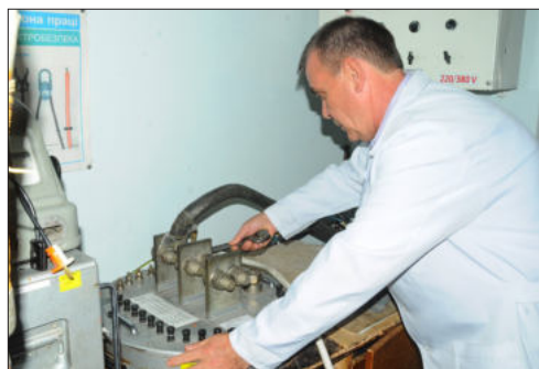
Начальник научно-технического отдела метрологического обеспечения электрических, магнитных, радиотехнических измерений и ионизирующих излучений Глушко В.П. проводит проверку трансформаторов тока
